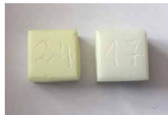
**Abb. 9:** Probe 24 wurde auf einem geschlossenen Sagger (Brennschale) gesintert. Probe 17 war im Sagger im gleichen Brand in einem verunreinigten Ofen.
